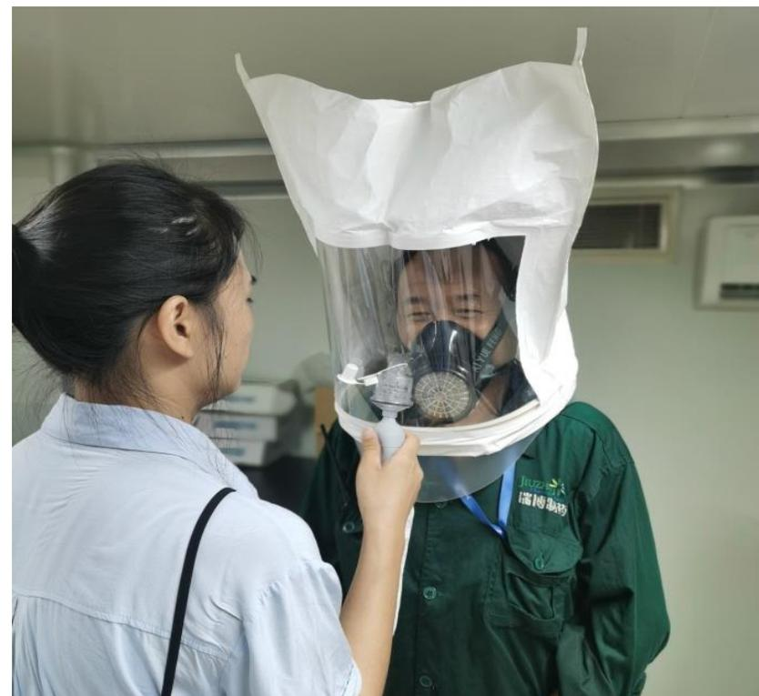
备注：定期对员工的RPE进行贴合性测试（Fit testing）。
