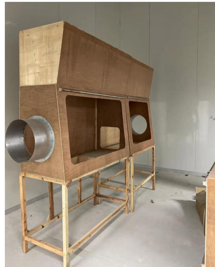
备注：设备定制之前，应采用木模实验，以确保设备使用中符合人机工程学。
