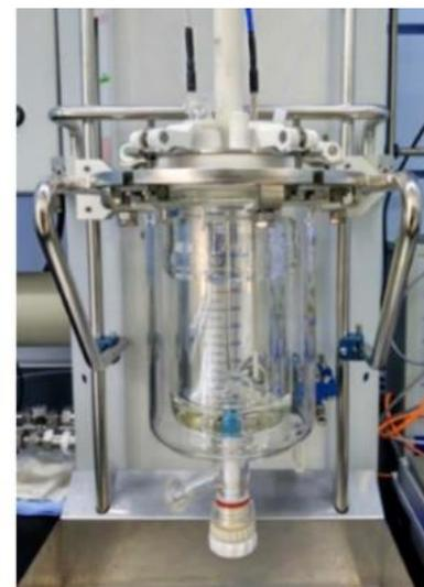
图1 全自动反应量热仪 RC1e
