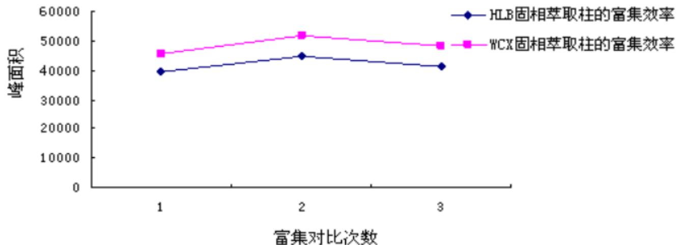
富集相同体积的污水，调节pH=3，分别上样，最后以6 ml 甲醇洗脱，N<sub>2</sub>吹至近干，1 ml含0.1%甲酸水定容
