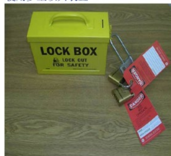
隔离装置的钥匙被放置在上锁箱的内部。
