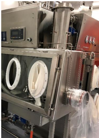
备料隔离罩 - 过筛机部分，有工具传递窗与废物传递窗
