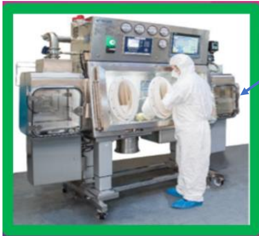
备料隔离罩 - 过筛机部分，有工具传递窗与废物传递窗
